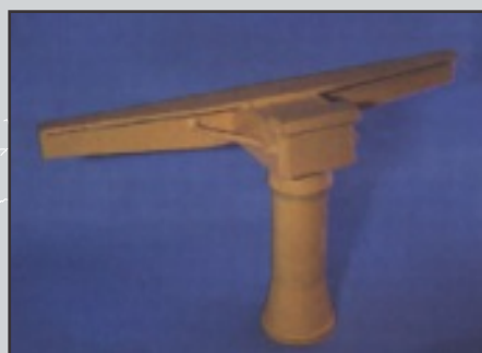
Трёхсторонний распределитель обрушения. Спроектирован как для предотвращения обвала пород, так и для поглощения энергии обрушения.
